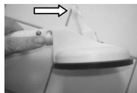
Zum Austausch des Saugkopfes drücken Sie den Arretierknopf an der Seite und ziehen den Saugkopf in Pfeilrichtung ab. Den neuen Saugkopf aufschieben bis er deutlich einrastet.
