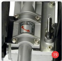
Wollen Sie den Rollstuhl in bestimmten Situationen schieben, müssen Sie die Bremsen entriegeln. Im Freilauf ist der Rollstuhl leicht zu schieben. Das Getriebe des Eltego ist mit Minischaltern ausgestattet, die automatisch die Steuerung deaktivieren, wenn der Freilauf aktiviert ist. Bei Betätigung des An-Aus-Buttons blinkt die Batterieanzeige neunmal, der Rollstuhl lässt sich nicht bedienen.
