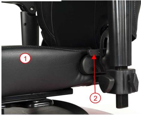
An der Rückenlehne (Übergang zur Sitzpolsterung) befindet sich ein Kipphebel (2). Ziehen Sie diesen Hebel nach oben, um die Rückenlehne zu entriegeln und nach vorne zu klappen (-75°), oder stellen Sie den Winkel der Rückenlehne ein (0°-22°).
