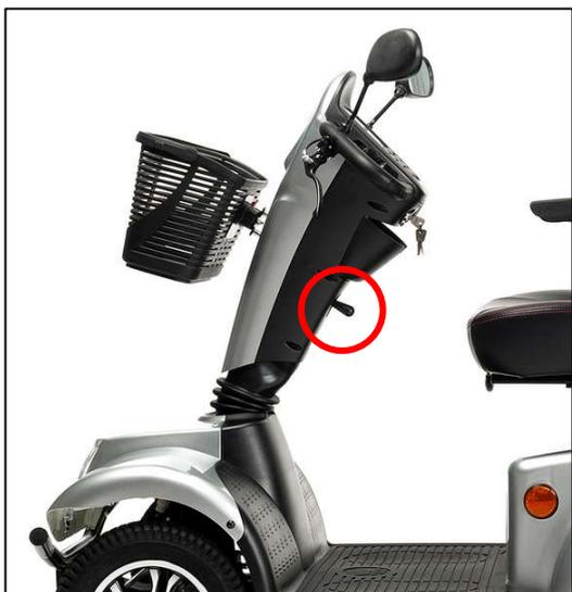
Die Lenkeinheit kann in viele verschiedene Positionen (stufenlos) passend für jeden Fahrer eingestellt werden.
