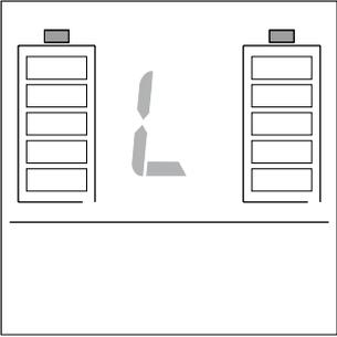
Bei Aktivierung der Tastensperre wird im Display der aktuelle Ladezustand der beiden Akku-Packs, sowie wechselnd ein „L“, die aktuell eingestellte Fahrstufe (1 oder 2) und bei Auftreten eines Fehlers der zugehörige Fehlercode angezeigt.
