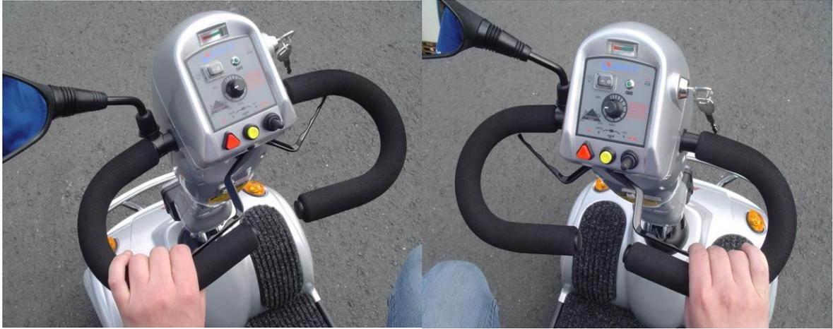
Warnung: Ziehen oder Drücken Sie nicht an beiden Hebelarmen gleichzeitig, weil so die Fahrhebelmechanik beschädigt wird.
