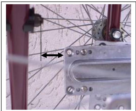
Abb. 8 Abstand Schraube v. Kreuzstrebe zu Rohrhalterung
