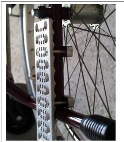
Abb. 3 Grundträger mit Rohrschellen
