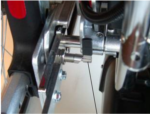
Bild 7: Hebel v. linkem Sicherungsbolzen oben, geöffnet
