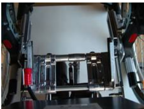
Bild 5, 5a: Antriebseinheit ohne Akku hinter Aufnahmen
