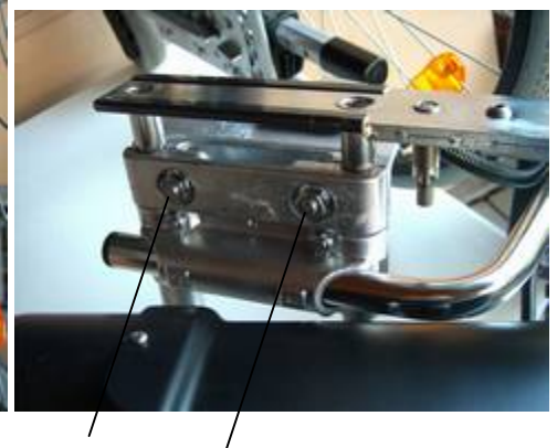
Bild 6: Spannrohrhalter zur Breitenverstellung
