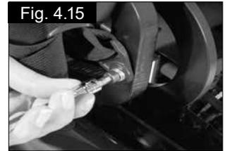
Die Länge des Beckengurts passend einstellen. Um den Komfort und die Sicherheit des Benutzers zu gewährleisten, sollte die Lücke nicht mehr als eine Handbreite betragen. Die Handbreite sollte mit dem normal gespannten Beckengurt gemessen werden und keine großen Lücken oder Schlaufen lassen (Fig. 4.16).
