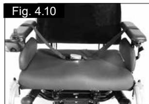
Die beiden anderen Enden des Gurts wie oben abgebildet durch die Lücke zwischen den Rückenpfosten und dem Rückenkissen führen. (Fig. 4.11)
