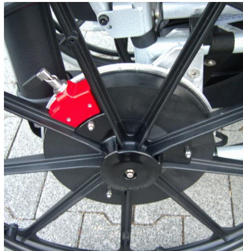
Bild 12 Bolzen bündig; Rad richtig angebaut
