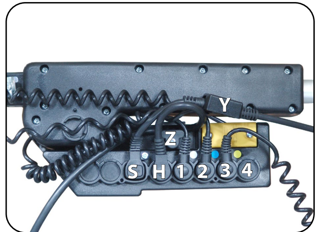
Abb. 6.2.05 - Steuerung mit Motorzuleitungen
