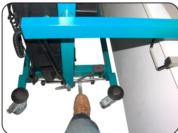
Abb. 9.3.06 – Betätigen des Vorspannpedals
