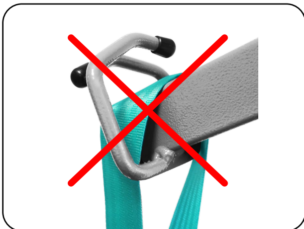
Abb. 6.4.03 - Gurtschleife falsch eingehangen
