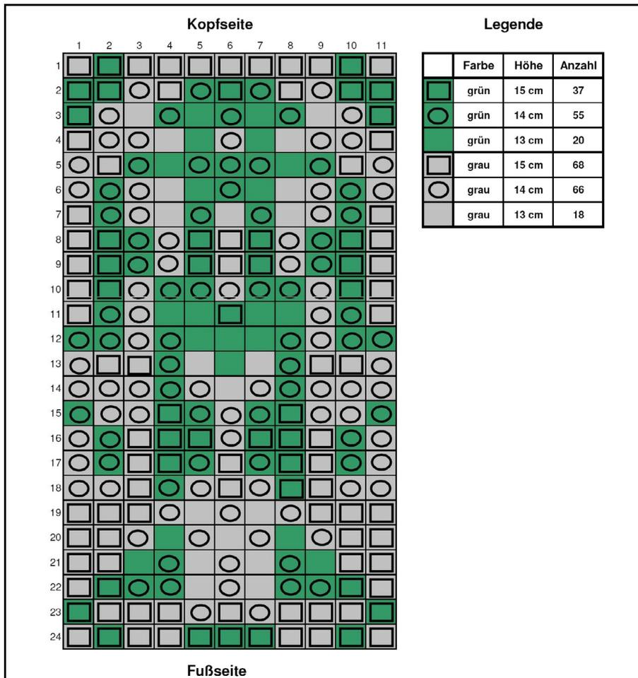
**Abb. 6.1.04 - aks-varioplus Standard-Steckschema 90 x 200 x 15 cm**
