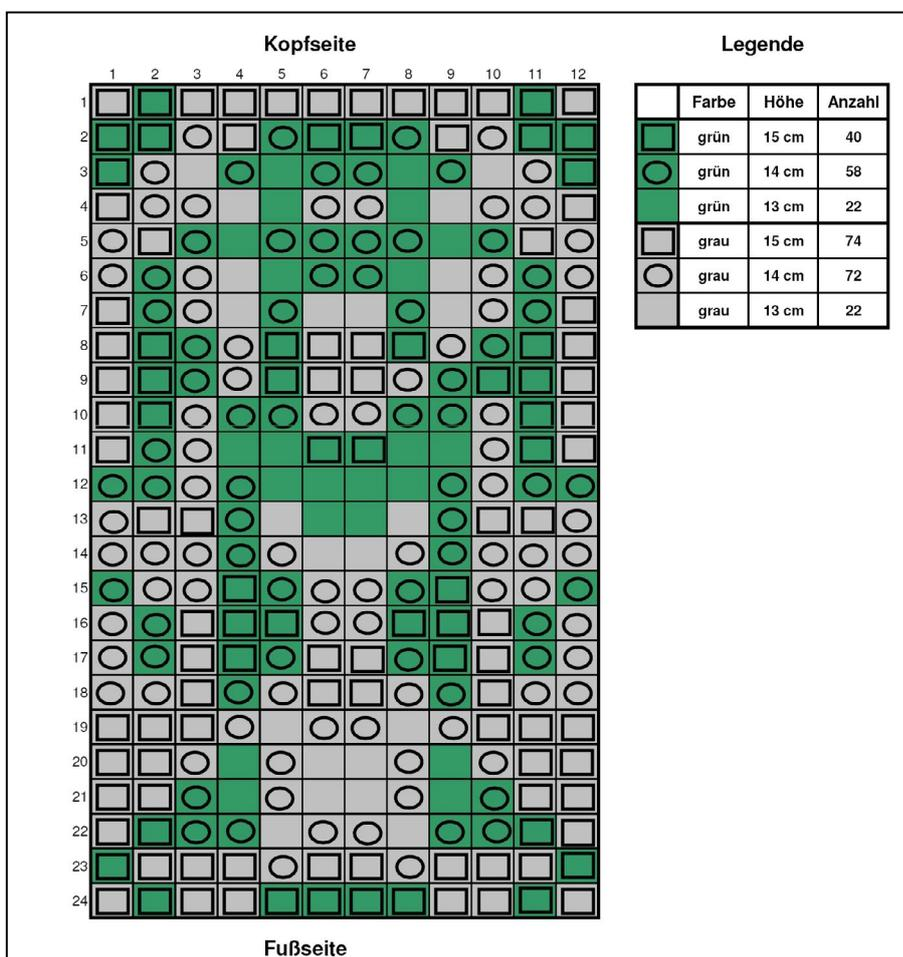
**Abb. 6.1.05 - aks-varioplus Standard-Steckschema 100 x 200 x 15 cm**
