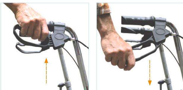
Zum Bremsen während des Gehens mit dem Rollator beide Bremsgriffe mit den Händen nach oben ziehen (siehe Bild). Immer langsam und gleichmäßig mit beiden Händen bremsen.
