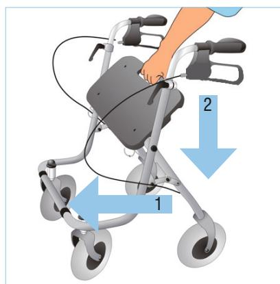
Plaats de rollator op de wielen. Druk het voorframe naar voren door een handgreep schuin naar achter en omlaag te trekken tot de rollator op vier wielen staat. Druk daarna de zitting omlaag totdat deze hoorbaar op de dwarsstang vastklikt.
