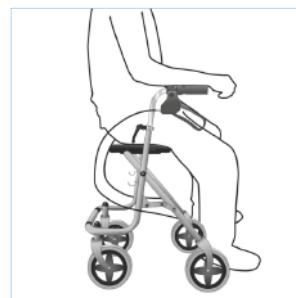
Als u de rollator wilt samenvouwen, trekt u de zitting en de rollator omhoog. Kantel de rollator tegen de looprichting in omlaag naar achteren, zodat het frame wordt ingevouwen (afbeelding A+B). De rollator kan vervolgens worden voortgetrokken (afbeelding C) of opgeborgen.
