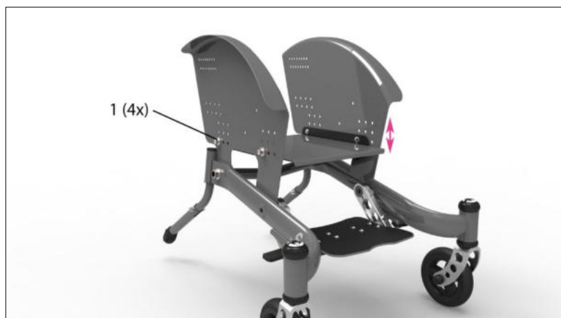
Abb. 9: Verschraubung der Sitzhalterung
